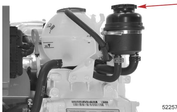
**IMPORTANT : Si l'huile n'est pas visible dans le réservoir d'huile, consulter le centre de réparation agréé Mercury Diesel.**
